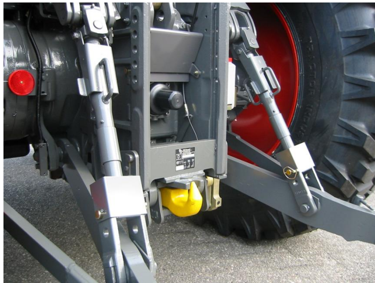
Abbildung 7a: Hitchanhängerkupplung an einem Standardtraktor (Foto: AGCO-Fendt)
