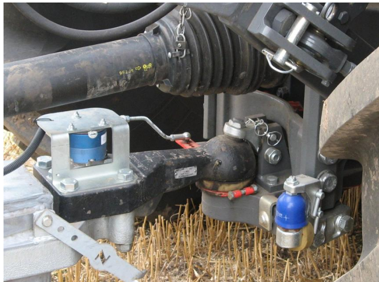
Abbildung 9b: Kugelkopfkupplung 80 an einem Standardtraktor (Foto: Fröba)
